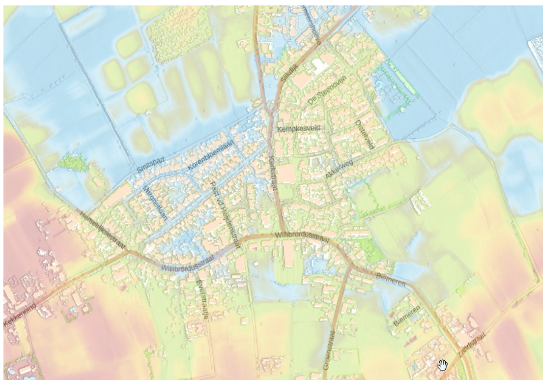
Afbeelding 1: De Willibrordusstraat en Biemerensloot zijn de eerste oost-west (lager) gelegen straten die overlast krijgen van water vanuit hoger gelegen gronden aan zuidzijde. (Hoogte t.o.v. N.A.P. gaat van rood (ca. 24,5 m), oranje (ca. 23,5 m), geel (ca. 23,0 m), groen (ca. 22,0 m) naar blauw (ca. 21,1 m) in de Willibrordusstraat.)
